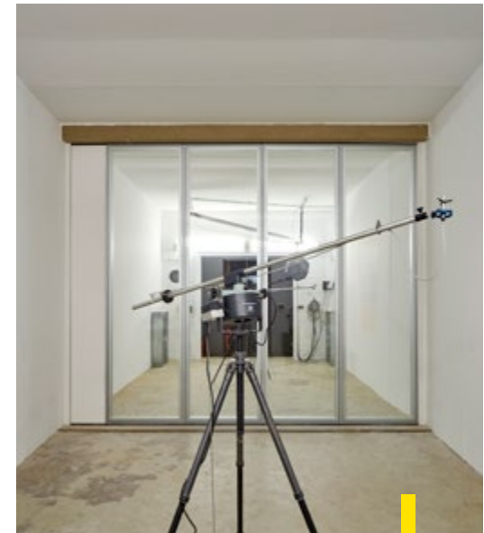
El tabique se compone a fin de probar su aislamiento acústico.
